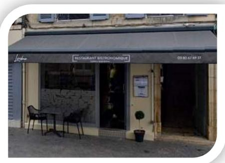
La présence d'une marche de 17 cm à l'entrée du restaurant empêche d'installer une rampe définitive sur le trottoir. Une rampe amovible de 1m de longueur et 2.4 m de largeur sera installée sur le trottoir. Le personnel de l'établissement sera formé à la manipulation de la rampe amovible. Un bouton d'appel avec pictogramme sera installé à l'entrée du restaurant.
